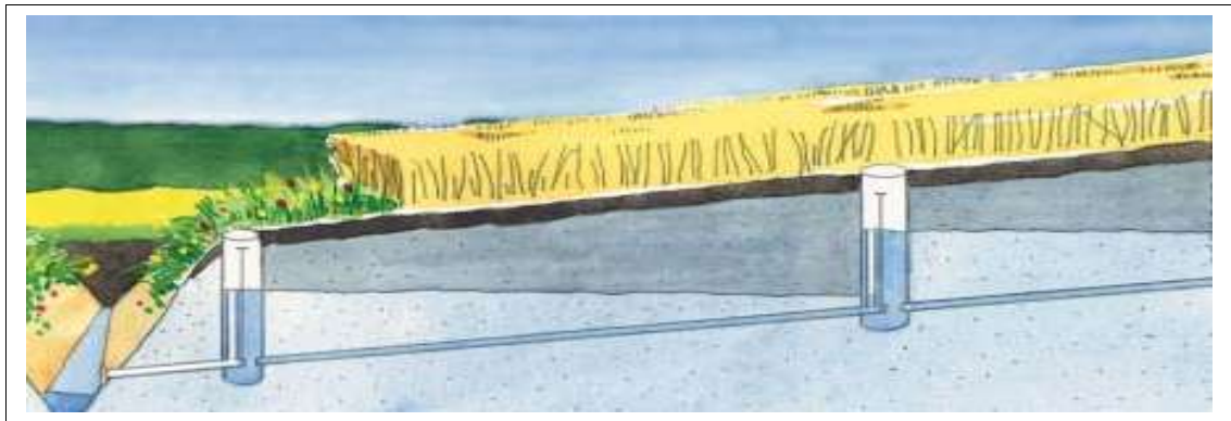
Bild 1. Principskiss över reglerbart dräneringssystem. Observera att lutningsförhållandet är överdrivet (JSM 2003:3).
