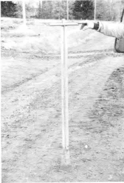
Kuva 3. Rassi, joka työnnetään putken päälle.
