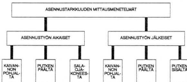
Kuvio 1. Salaojan asennustarkkuuden mittaukseen käytettyjä menetelmiä mittauksen tekoajan ja mittauskohteen mukaan jaoteltuna.
