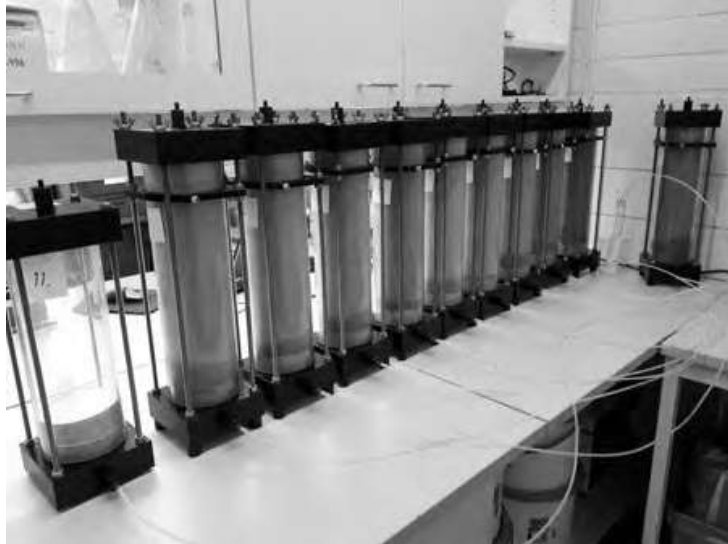
Kuva 1. GTK:n Kuopion laboratorioon rakennettu kolonnikoejärjestelmä koostuu 10 varsinaisesta kolonnista sekä yhdestä vertailukolonnista. 1
