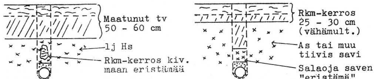
2. Virheellinen ojakaivannon täyttö savimaalla
