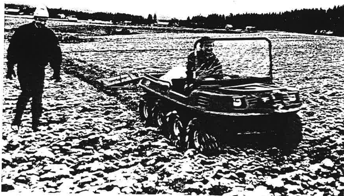
KUVA 6 Maatutkaa vedetään amfibioajoneuvolla
