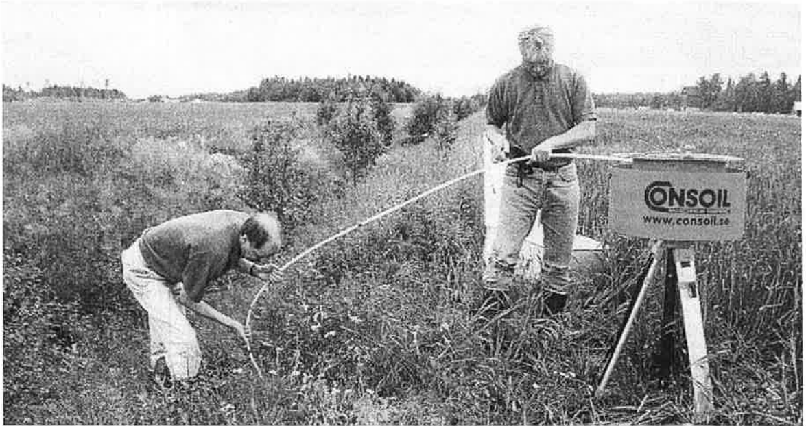
Kuva 6. Anturin työntäminen salaojaan
