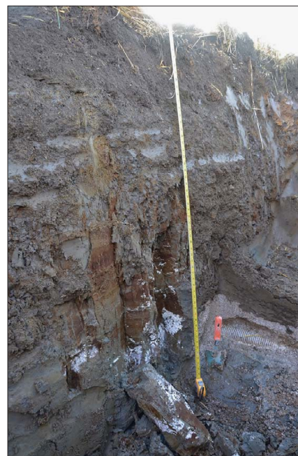
Kuva 2. Kalsiumkarbonaattisuspension tunkeutuminen maahan alhaalla oikealla näkyvästä salaojaputkesta. (Kuva: Rainer Rosendahl.)
