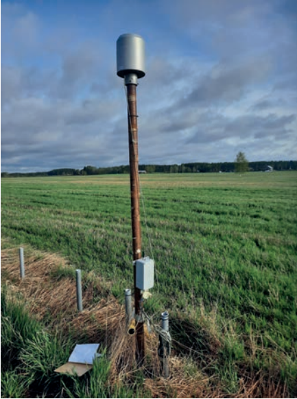
Kuva 5. Pohjavedenpinnan syvyyttä ja sademäärää mitataan jatkuvatoimisella mittarilla.
