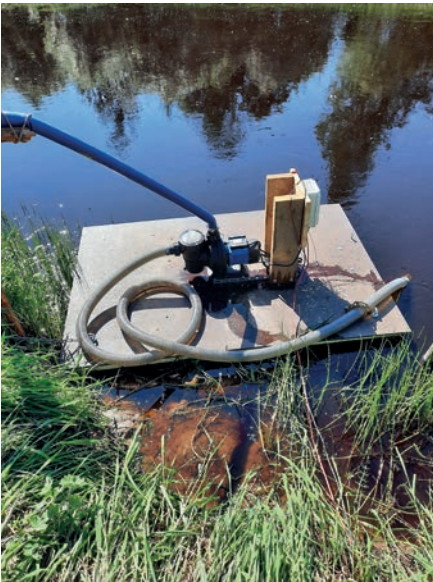
Kuva 6. Aurinkopaneelitoiminen pumppu asennettiin joessa lautalle, ja aurinkopaneeli joenpenkalle.
