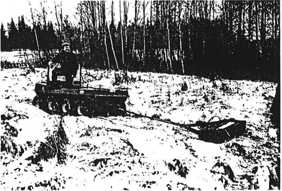
Kuva 6. Maatutkaa vedetään amfibioajoneuvolla.
