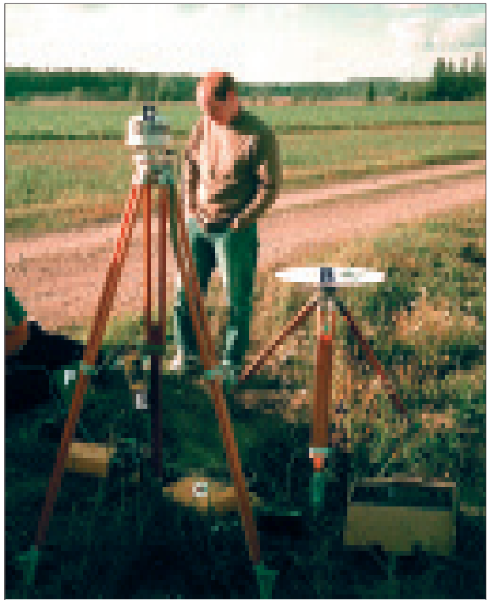
Kuva 9. RTK-mittauksessa tarvitun tukiasemapisteen (A) sijainnin mittaamisessa käytetty laitteisto. Etualalla differentiaalivas-taanotin Trimble Pro Beacon (D = antenni, E = RTCM-radio) ja taaempana GPS-laitte Trimble 7400 series (B = antenni, C = GPS). Mittauksen ohjaamiseen ja datan tallennukseen käytetty kannettava tietokone (F).
