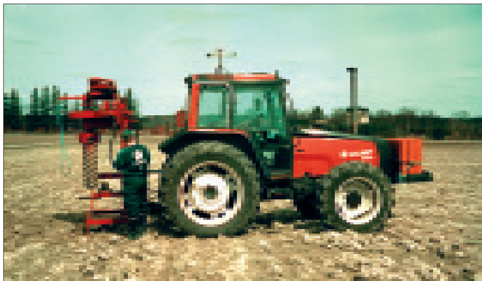
Kuva 5. Maanäyteliერიoiden kairauksessa käytetty koneellinen kaira. Traktorin eteen on rakennettu lieriöiden kuljetusteline.
