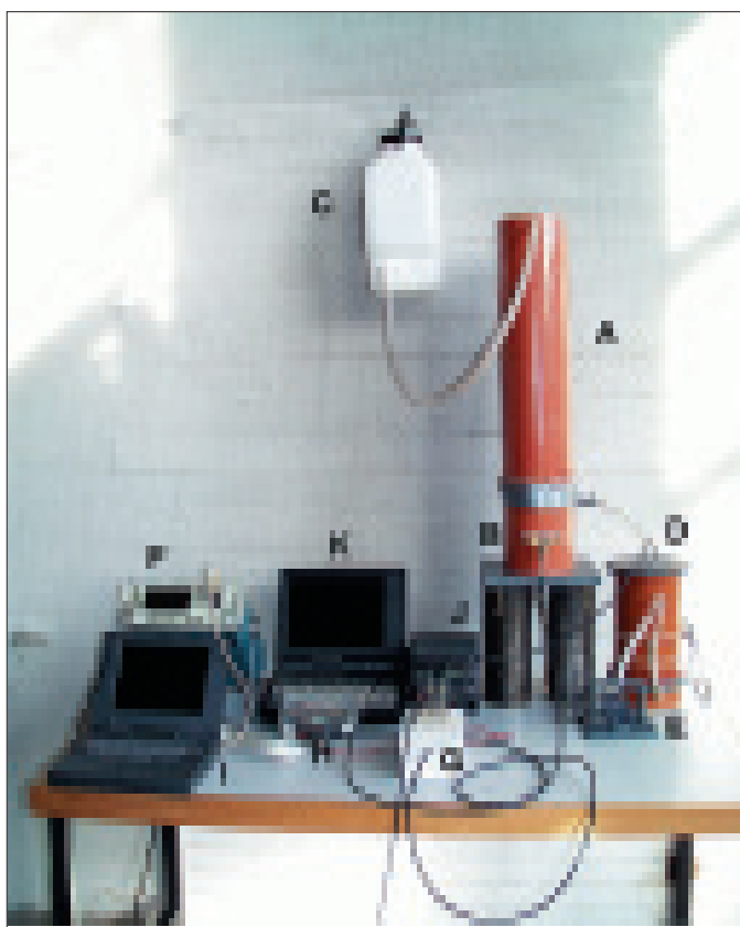
Kuva 6. Lieriömittauksissa käytetty laitteisto. A. maanäytelieriö, B. lasikuulalieriö, C. mariotti-astia, D. lasikuulalieriö maanäytelieriön reunavesille, E. kippilaskuri, F. kaapelitutka (TDR), G. multiplekseri, H. releistö, I. TDR-mittausta ohjaava tietokone, J. virtalähde, K. virtausmittausta ohjaava tietokone.
