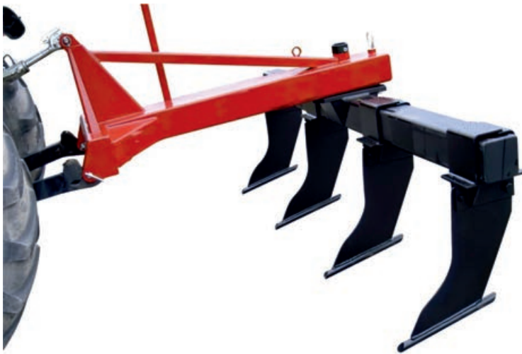
Jankkuroinnilla eli mekaanisella kuohkeutuksella rikotaan tiivistymiä.
