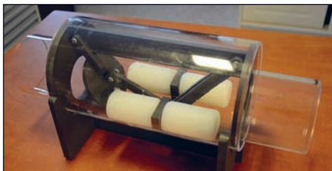
Kuva 8.8 Säätöventtiilin asennus (ylh.), Säätöventtiilin pienoismalli (alh.), josta näkyy laitteen toimintaperiaate. Kun venttiili on veden täyttämä kellukkeet kääntävät läpän, joka sulkee venttiilin tiettyyn paineeseen asti. (Kuvat Rainer Rosendahl)
