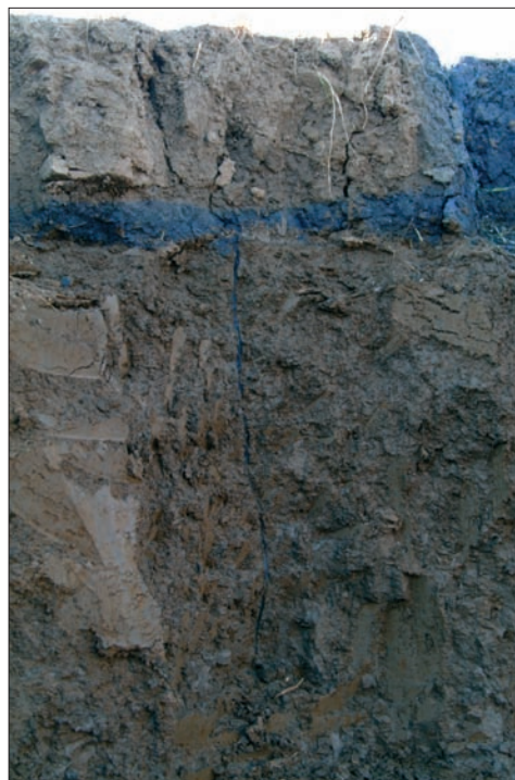
Kuva 2.15 Savimaan makrohuokostoa, joka on verkostoitunut. Maan pinnasta kaadettu värjätty vesi painuu alaspäin halkeamassa. Muokkauskerroksen alaosaan se lähtee valumaan sivuttaissuunnassa. Jankossa ollut lierokäytävä johtaa sen yläpuolelle kertynyttä vettä syvälle maaprofiiliin oikovirtauksena. Lähde: Shipitalo ym. (2004). (Kuva Visa Nuutinen)
