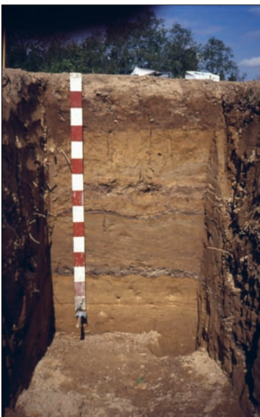
Kuva 2.13 Maannosprofiili hienossa hietamaassa Reh-tijärvellä, Jokioisilla. Yli 90 cm:n syvyydellä maa on pääasiassa karkeaa hietaa, jossa ohuita aitosavi-kerroksia. (Kuva Markku Yli-Halla)
