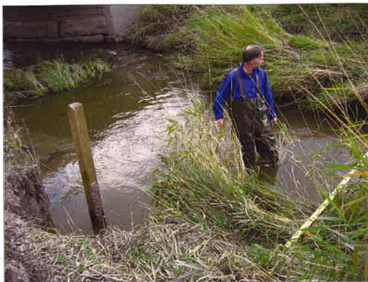
Kuva 8. Vedenkorkeusasteikko Gårdskullan sillan yläpuolella.
