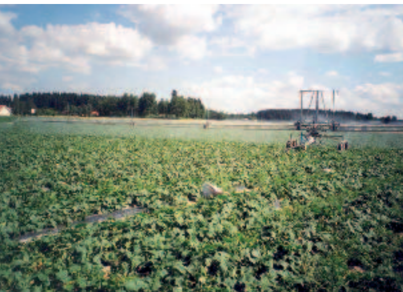
Kuva 9. Sadetuskoneeseen liitetty sadetuspuomi, jossa on useita suuttimia 1–2,5 metrin välein kasteluveden syöttöä varten. (Kuvat Työtehoseura)
