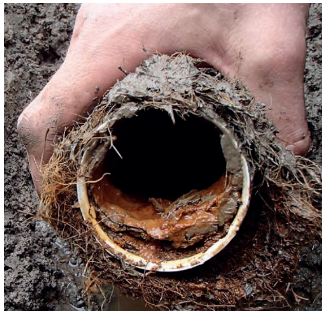
Kuva 12. Salaojiin virtaava vesi kuljettaa mukanaan hienoaainesta, joka voi tukkia putken. Ympärysaineella pyritään parantamaan putken vedenottokykyä ja estämään hienoaaineksen pääsy putkeen. Eri suodatinmateriaalien kykyä estää hienoaaineksen pääsy putkeen on tutkittu mm. kaivamalla putkia esiin. Kuva a) putkeen kertyneessä maa-aineksessa näkyy kerroksellisuutta, ja vuonna 1924 arveltiin putken liettymisen syntyneen kahtena peräkkäisenä vuonna (Keso 1924), ja b) kookoskuidulla esipäällistettyyn putkeen on kerääntynyt sekä maa-ainesta että ruostetta, vaikka päällyste ei ole juurikaan hajonnut (Äijö ja muut 2017).
