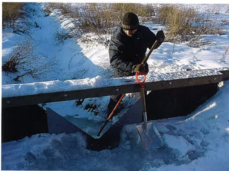
Matti Keto poistaa jäätä mittapadon aukolta Espoossa. Teknillisen korkeakoulun vesilaboratorion kenttätöitä on keskitetty läntiselle Uudellemaalle, lähelle opinahjoa.
